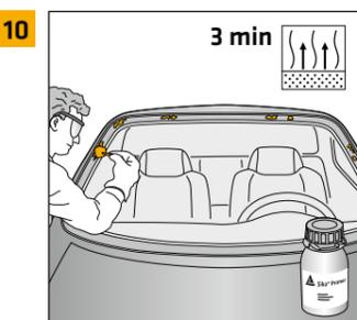
**10** Kleinere Lackschäden mit Sika® Primer-507 ausbessern
