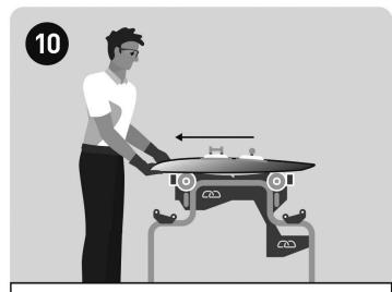
Montieren Sie einen Saugheber horizontal zum oberen Rand der Windschutzscheibe und zwei vertikal zu den Seiten der Scheibe. Ziehen Sie dann die Windschutzscheibe vorsichtig nach hinten.
