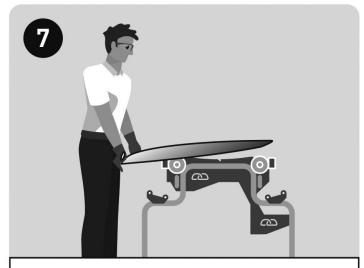
Manchmal ist die Windschutzscheibe mit einem Gummirahmen versehen. Drücken Sie in diesem Fall mit beiden Händen leicht auf den unteren Teil der Windschutzscheibe, um diese leicht anzuheben.
